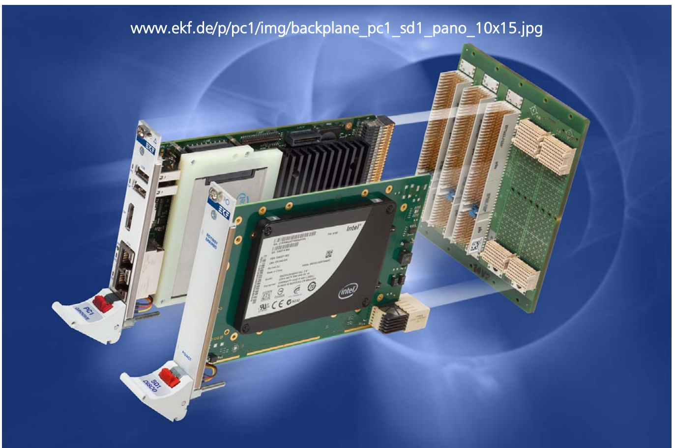
2012: Hybrides System CompactPCI® Serial und CompactPCI® Classic
