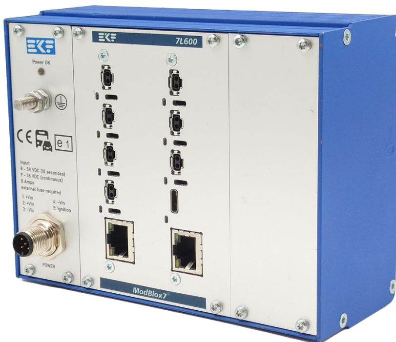
**Hamm, 09.04.2024:** Zur Embedded World stellt EKF sein erstes ModBlox7™-basiertes Produkt vor: Der 7L600 ist ein robuster Single-Pair-Ethernet-Switch, der Modularität mit hoher Rechenleistung und modernsten Schnittstellen verbindet. Der kostengünstige Switch eignet sich vor allem als multifunktionales Gateway in unterschiedlichsten IIoT- oder Retrofit-Anwendungen, kann aber durch die On-Board ARM-CPU auch als Edge Computer zur (Echtzeit-)Datenvorverarbeitung und Datensammlung dienen.
