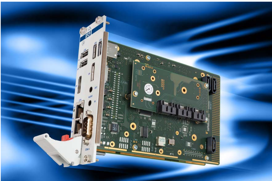
PCS-BALLET w. C43-SATA Internal Cable Connector Module
