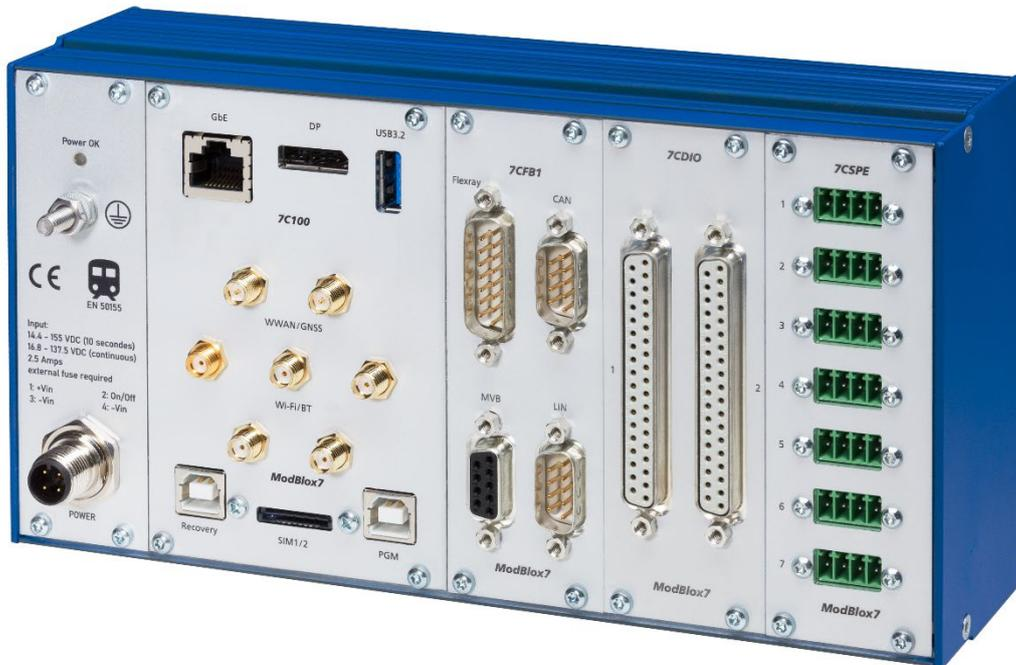
**Hamm, 18.10.2022:** Unter der Bezeichnung PICMG® **ModBlox7™** arbeiten mehrere Hersteller derzeit an einem neuen Standard für modulare Industrie PCs, der die Vorteile skalierbarer Systeme wie z.B. CompactPCI® mit kostensparenden Box-PCs kombinieren soll.
